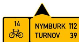
Informativní dopravní značka směrová IS 19b Směrová tabule pro cyklisty (se dvěma cíli)
