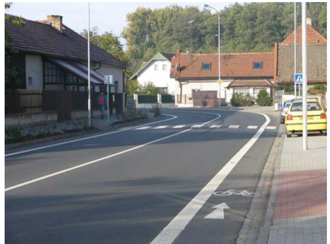
Obr. 3.15b: Příklad vedení jednosměrného jízdního pruhu pro cyklisty v HDP podél parkovacího pruhu (Velký Osek)
