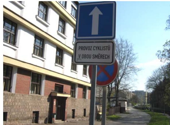
Obr. 2.2b: Umožnění obousměrného provozu cyklistům v jednosměrné ulici Mánesovo nábřeží (směr z centra)
