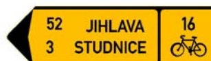
Informativní dopravní značka směrová IS 19d Směrová tabule pro cyklisty (se dvěma cíli)
